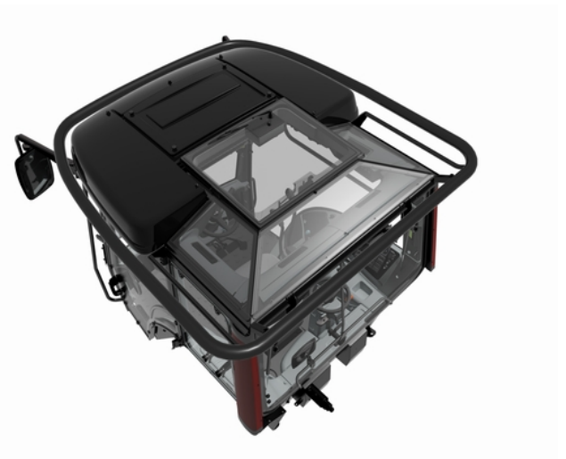
(ejemplo de FOPS integrado en la cabina)
