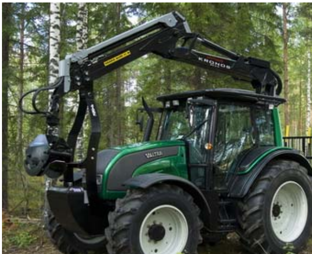
(ejemplo de FOPS integrado en la cabina)
